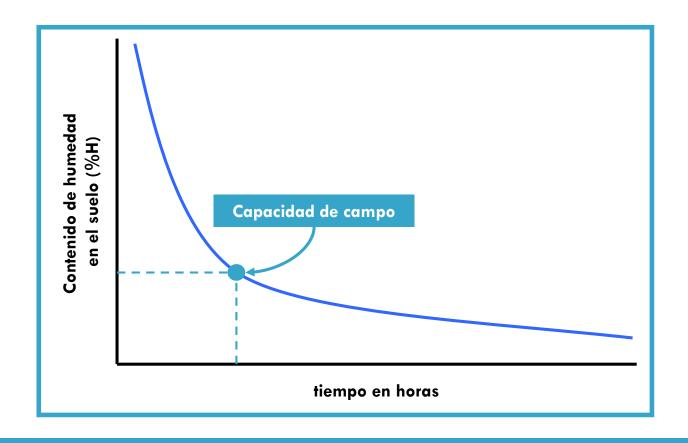
Se prepara un cuadro de terreno de 1 m² y se satura de agua y se cubre para evitar la evaporación. A partir de que el suelo está saturado, se comienzan a tomar muestras cada 2 horas para llevarlas al laboratorio y después de su secado a la estufa, se determina su contenido de agua. Cuando se nota una inflexión en la gráfica resultante, se determina que toda el agua gravitacional se ha infiltrado y este valor es el porcentaje de humedad que corresponde a la Capacidad de campo (CC).
